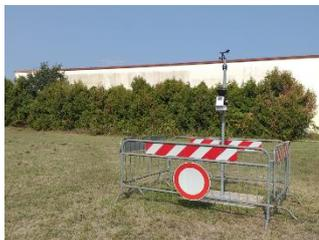
di ottobre è entrata in funzione **la nuova stazione meteorologica di Spinadesco** installata nello spazio antistante il cimitero. *Si tratta di una strumentazione atta a rilevare i principali parametri atmosferici quali, temperatura, umidità, pressione atmosferica, velocità e direzione del vento, pioggia (intensità istantanea, cumulata giornaliera, mensile e annuale), nonché tutti gli altri parametri derivati.*
